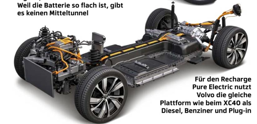
Für den Recharge Pure Electric nutzt Volvo die gleiche Plattform wie beim XC40 als Diesel, Benziner und Plug-in
